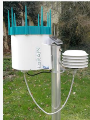
Anschließend muss das Metallrohr so gedreht werden, dass die Solarzelle nach Süden zeigt und das Gerät mit ausreichend Strom versorgen kann.
