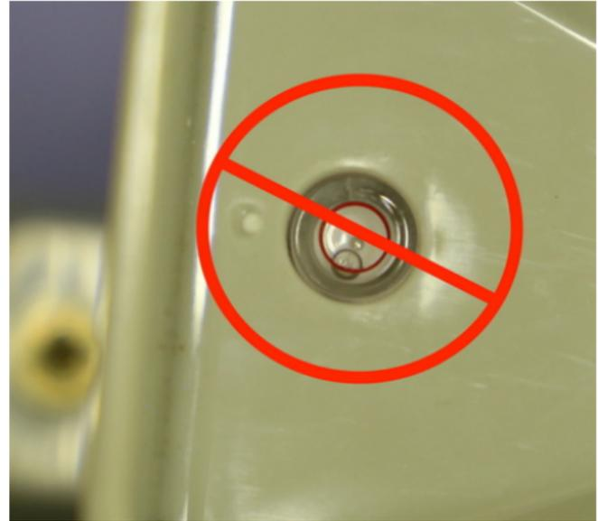
Bei der Ausrichtung der Niederschlagswippe kann anhand einer kleinen Wasserwaage in der Wippe überprüft werden ob sie in Waage ist. Es sollte so aussehen wie auf dem linken Foto.
