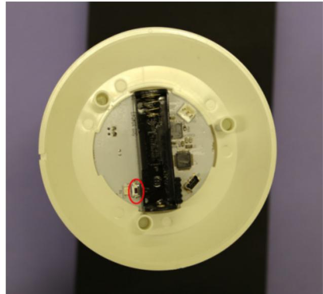
Gehe dafür raus, am besten dorthin, wo du den MESSI später aufstellen möchtest. Drücke mit dem Elektroschraubenzieher oder etwas anderem Spitzen den „Resetknopf“ durch das kleine Loch (roter Kreis links). Der „Resetknopf“ ist rechts nochmal ohne Unterlamelle rot eingekreist.
