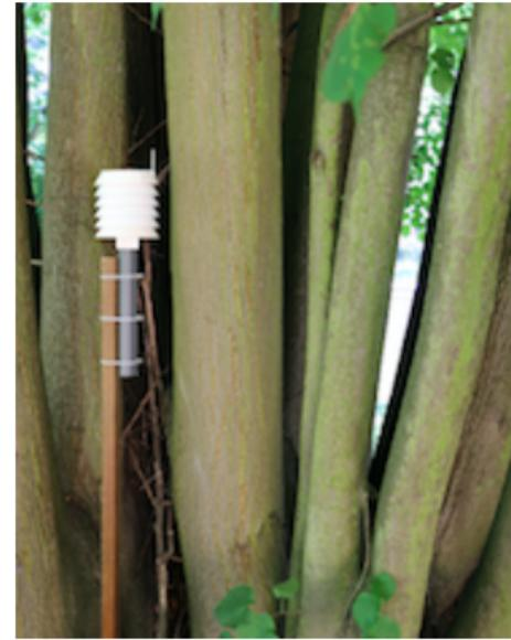
... der MESSI **nicht!** zu nah an einer Wand steht (möglichst mehr als 3m entfernt) oder unter einem Baum, Vordach oder Ähnlichem, sondern ...
