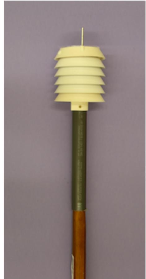
Eine weitere Möglichkeit ist, dass du den MESSI mit Kabelbinder an einer Stange oder Zaunpfahl befestigst.
