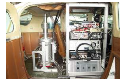
POLIS (UNI München) Lidar installation
