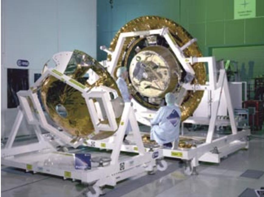
▲ HUYGENS kurz vor dem endgültigen Zusammenbau. Im Zentrum des sechseckigen Rahmens ist der eigentliche Sondenkörper zu sehen (Bild: ESA).
