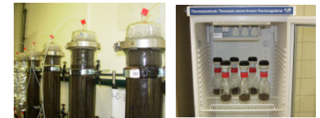
Foto 7: Säulentestanlage Foto 8: Respirationstest
