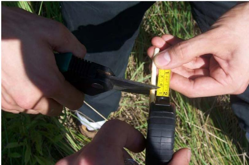
Zurechtschneiden des Bohrkerns
