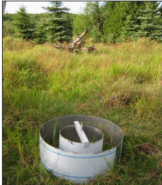
**Abb. 12:** Eingetriebenes Doppelring-Infiltrometer mit Messbrücke
