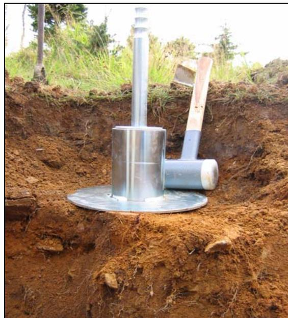
**Abb. 11:** Einschlagvorrichtung für Stechzylinder mit Einschlaghammer
