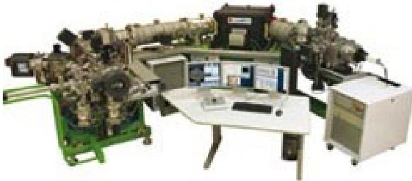
SIMS ist ein extrem leistungsfähiges Verfahren zur Bestimmung von Isotopenverhältnissen.
