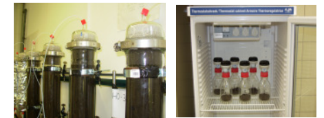
Foto 7: Säulentestanlage Foto 8: Respirationstest
